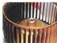
換気扇内部ファンの樹脂化した油汚れ
