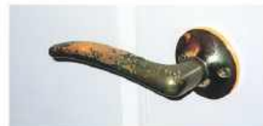
濡れた手で触ったまま放っておくと、金物表面の塗装が劣化してしまいます。
