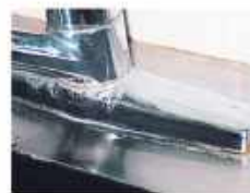
水栓金具に蓄積した水道水中の成分のケイ酸が、湿潤と乾燥を繰り返して堆積した汚れ
