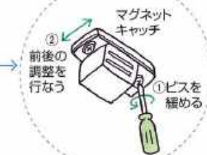
ネジを緩めて、受プレートに当たるように マグネットキャッチを移動
