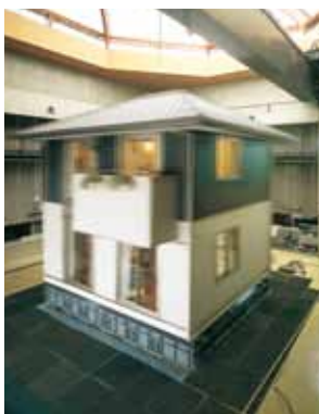
1979年在住宅行业首次进行了实体大震动实验。之后也多次进行了实验和验证，造就了“防震”和“减震”等技术
