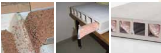
粉碎瓦砾的边角料，用作吸收振动的填充料
