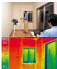
在人工气象室的隔热性能验证实验
