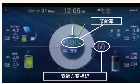
◀ HEMS的画面(例) 使发电量、蓄电量、购买电量、热水储量等能源可视化,显示有效利用能源的指标节能率,促进居民的节能行动,并验证其效果
