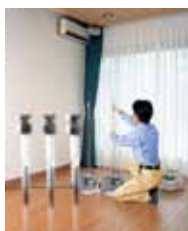
调查住宅内的VOC浓度和过敏性物质。该研究成果造就了“防化学物质污染规格”
