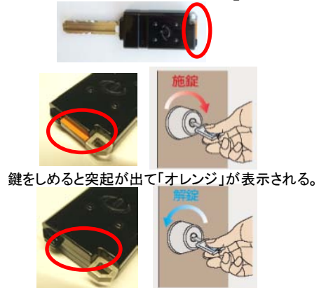
鍵をあげると突起が引っ込み「オレンジ」の表示が消える。
