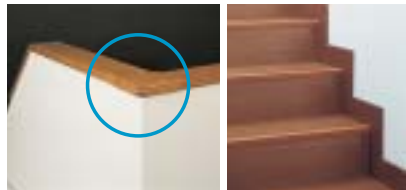
階段笠木コーナー部の角をなくすために、丸みを持たせた専用部材、弾力性のあるすべり止めを段板に埋め込み、段板の出っ張りをなくした安全配慮階段等、階段の安全性をより一層高めるための部材開発を行いました。
