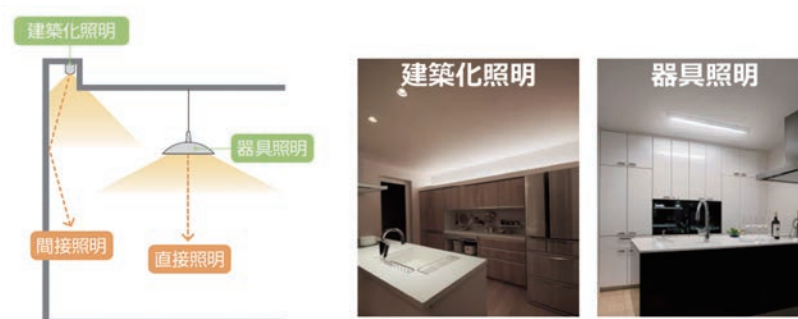
【図3】建築化照明と器具照明
