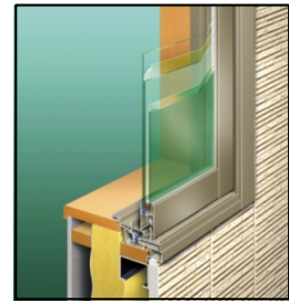
◆窓断熱 遮熱断熱ペアガラス
