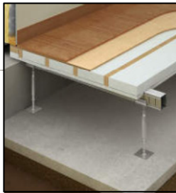
◆床下断熱 ポリスチレンフォーム80mm
