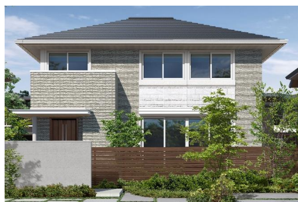
オリジナル外壁「ダインコンクリート」の新柄「クラフトモザイク」（特許出願中） 目地が目立たず、クラフト感を活かしたデザイン。世界初となるフッ素保護層のあるフッ素光触媒塗装を採用し高い耐久性を備える。
