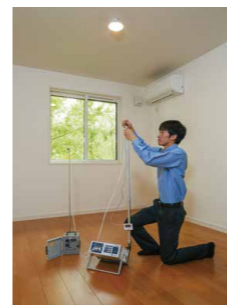
住宅内のVOC濃度やアレルギー原因物質を調査。研究成果が空気環境配慮仕様「エアキス」につながりました
