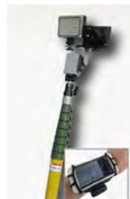
小屋裏点検ロボットカメラを使用して点検を行います
