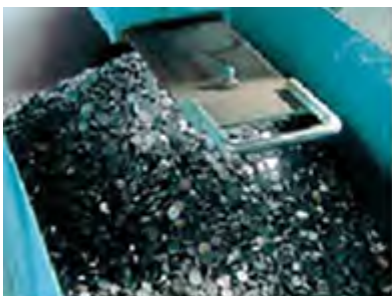
ボルト穴開けで発生したパンチくず
