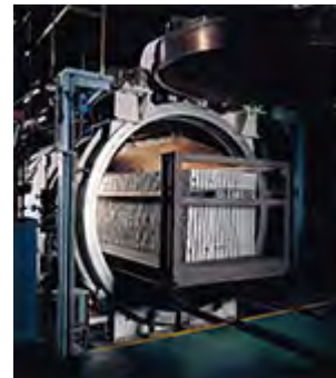
完全密封のタンクの中で高温・高圧で約20時間養生（二次養生=オートクレーブ養生）
