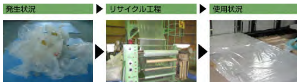
廃梱包材（ポリエチレン）を2階床ALC防湿シートの原料として使用
