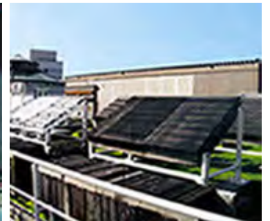
屋上で実施中の曝露試験
