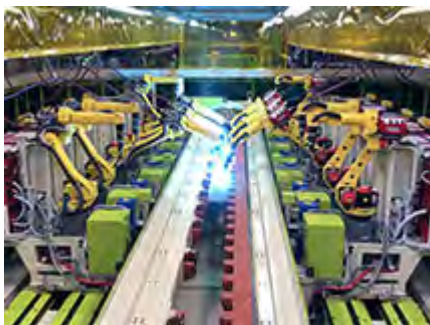
山口 工場「βシステム」梁製造ライン（完全邸別生産）
