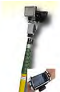
小屋裏点検ロボットカメラ
