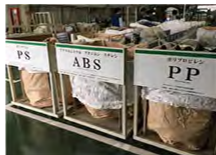
資源循環センターでは樹脂だけで最大20種に分別される
