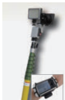
小屋裏点検ロボットカメラを使用して点検を行います
