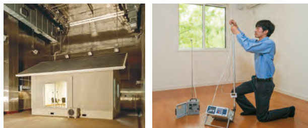
人工気象室での断熱性と快適性の検証実験
