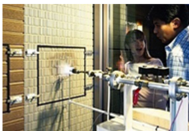
実際に外壁に炎を当てる実験で耐火性を確認（関西 住まいの夢工場「シャーウッドラボ」）
