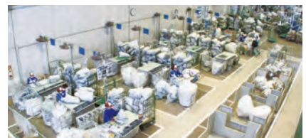
資源循環センターでのプラスチック類の分別
