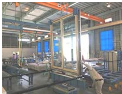
浅井工場のダイパネル複合工程
