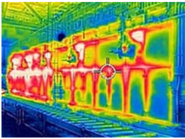
断熱化前の表面温度分布（高温）
