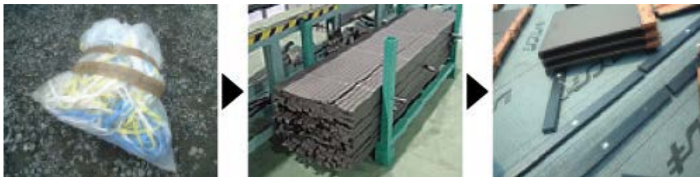
廃梱包材（ポリプロピレン）を瓦製の原料として使用
