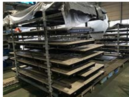
架台改造による積載効率向上
