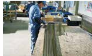
サッシ枠の分解(金属とガラスを分別)
