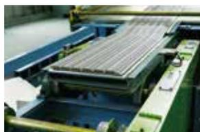
十分に練り上げた材料を金型に通して「ベルバーン」の基本的な形と柄を成形
