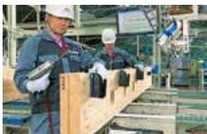
構適用金物を正確に取り付けた状態で出荷することで、施工現場での作業を軽減
