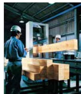
シャードウッド構造材の梁の曲げ強度試験。徹底した生産品質管理を実施
