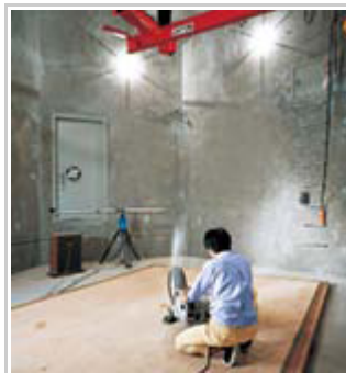
残響室での床衝撃音・ 遮音性能実験
