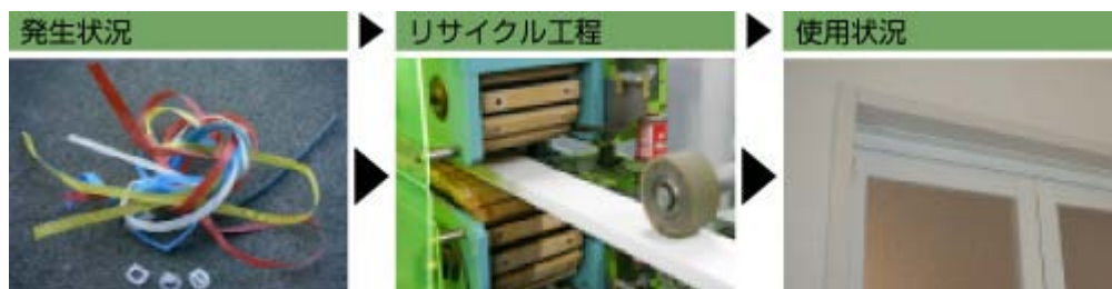
廃梱包材（ポリプロピレン）をシャーマゼンの浴室出入り枠の原料として使用
