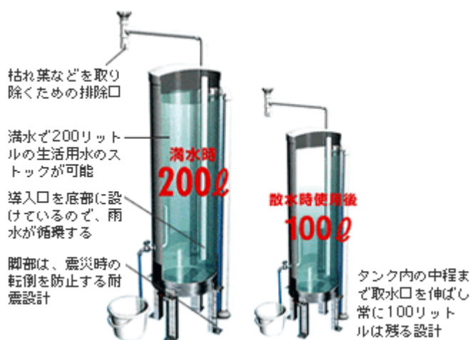
エコロジー&セーフティの雨水利用タンク
