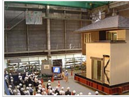
「シーカス」 実大振動台実験
