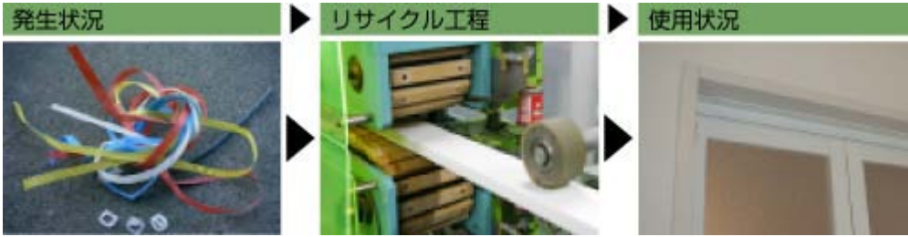
廃梱包材（ポリプロピレン）をシャームゾンの浴室出入り枠の原料として使用
