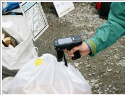
図3 施工現場での情報登録 ( 郵や廃棄物種類などの情報紐付け)
