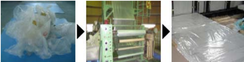
廃梱包材（ポリエチレン）を2階床ALC防湿シートの原料として使用
