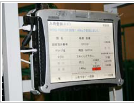
図7 ICタグ識別コードからASN※（次世代型ゼロエミッションでは回収現場での登録情報）との照合
