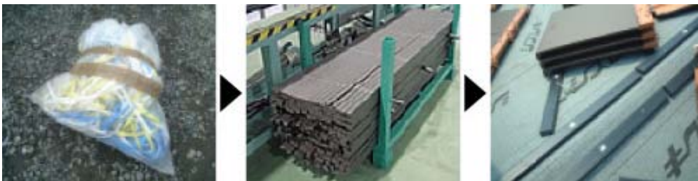
廃梱包材（ポリプロピレン）を瓦棧の原料として使用
