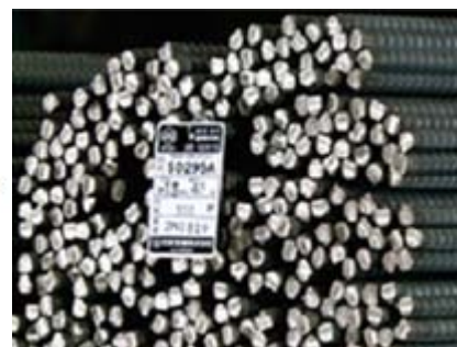
リサイクルされた鉄筋
