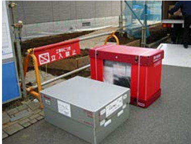
設備重機器用リターナブル梱包 何度も繰り返し使用できます。
