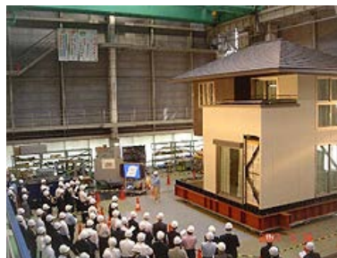
SHEQAS 実大振動台実験
