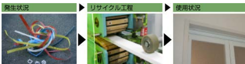
廃梱包材（ポリプロピレン）をシャーマゾンの浴室出入り枠の原料として使用
