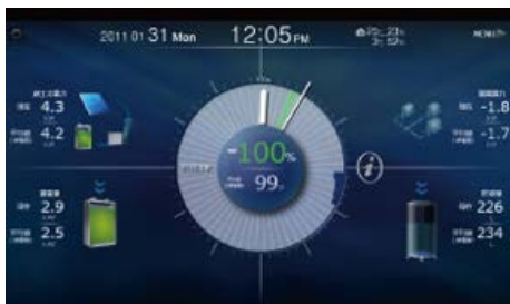
◀HEMSの画面(例) 発電量・蓄電量・買電量・貯湯量などのエネルギーを可視化、効率的なエネルギー利用の指標であるエコエネ率も表示し、居住者の省エネ行動を促進、その効果を検証します
