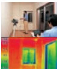
人工気象室での断熱性検証実験
