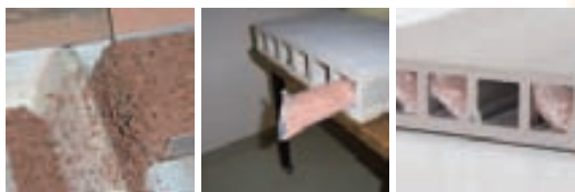
瓦の端材を破碎し、振動を吸収する充填材として使用
