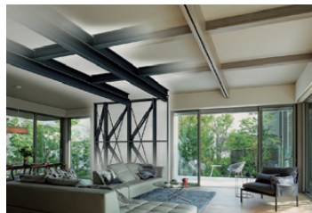
当社標準梁の約10倍の強度*の「ダイナミックビーム」 ※断面2次モーメント(梁の曲がりにくさ)比較
