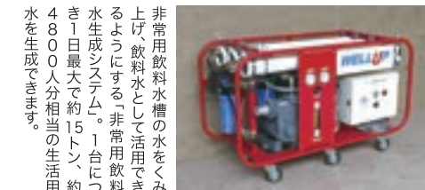
非常用飲料水槽の水をくみ上げ、飲料水として活用できるようにする。非常用飲料水生成システム。1台につき1日最大で約15トン、約4800人分相当の生活用水を生成できます。
