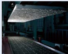
耐火性・耐久性、デザイン性に富む最高級外壁「ダインコンクリート」の製造ライン
